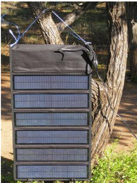
A ház berendezései egy 12 V-os napelemtől működnek.
